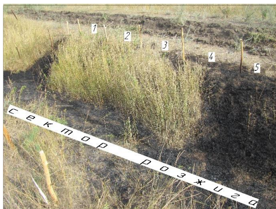
Рисунок 4 - Результаты исследования огнезадерживающих свойств экспериментальных секторов обработанных ГА – фото участка справа
