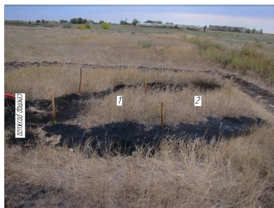
Рисунок 8 - Эксперимент с фланговым распространением пламени - вид на секторы с правого фланга
