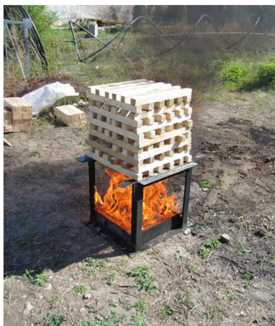
Рисунок 2 – Лабораторный метод исследования эффективности тушения
