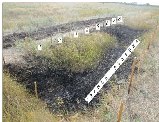
Рисунок 5 - Результаты исследования огнезадерживающих свойств экспериментальных секторов обработанных ГА – фото участка слева
