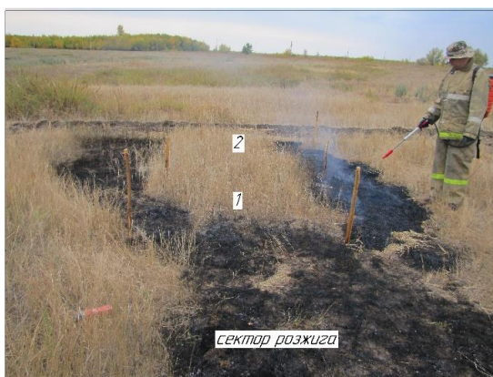
Рисунок 7 - Эксперимент с фланговым распространением пламени - вид со стороны сектора розжига
