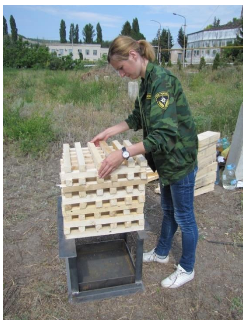
Рисунок 2 – Лабораторный метод исследования эффективности тушения
